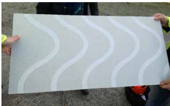
Vzorek sklobetonové desky obkladu fasády
